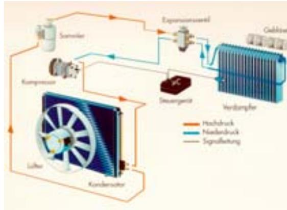
Eine Klimaanlage ist ein komplexes System, das im Prinzip wie ein Kühlschranks funktioniert, welcher der Innenluft in einem geschlossenen Kreislauf die Wärme entzieht.
