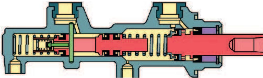
**R** Bei intakten Bremskreisen ist der Druck in beiden Kreisen gleich hoch.
