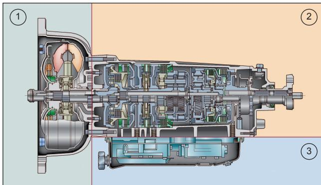
2 **Planetengetriebe (Getriebe)**
