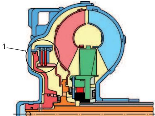
a) Markieren Sie im Drehmomentwandler den Ölstromverlauf ab dem Pumpenrad mit Pfeilen!
