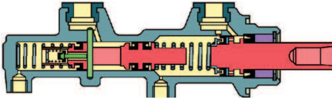
\_\_\_ Bei intakten Bremskreisen ist der Druck in beiden Kreisen gleich hoch.
